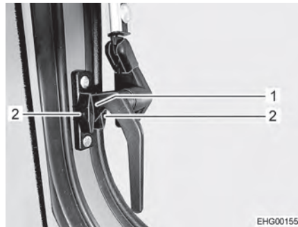
Afb. 43 Vergrendelingshendel, zijkant (stand "continue ventilatie")
