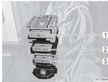
Afb. 110 Zekeringen naast elektroblok (Fiat/Citroën)
