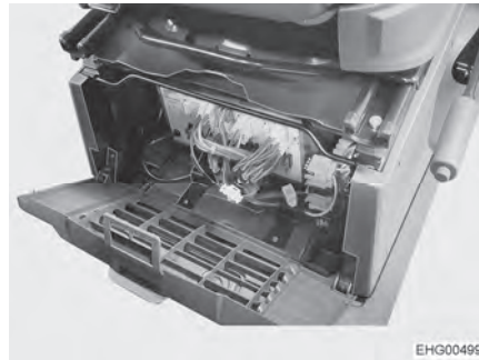
Afb. 98 Inbouwplaats elektroblok (Fiat/Citroën)
