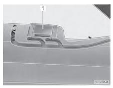
Fig. 31 Guide (ventilation position)
